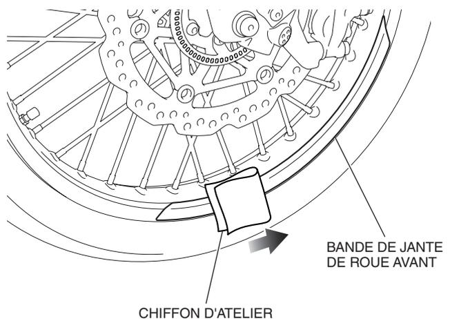
5. Installez la bande de jante de roue avant de la même manière que sur le côté diagonal.
